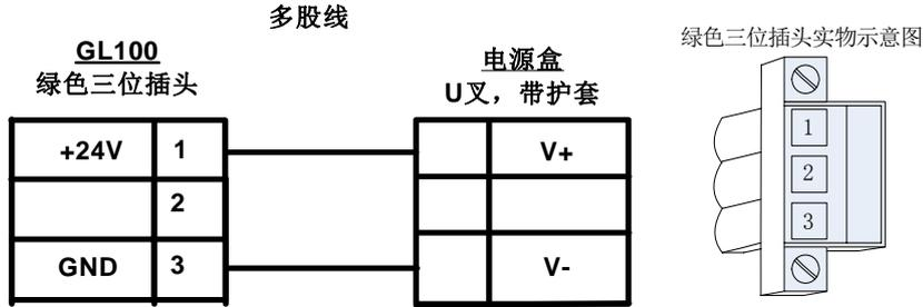
图 2-2-6-1 电源输入线
