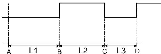
使用步进电机时（设定位置参数NO.6#6=0）：
