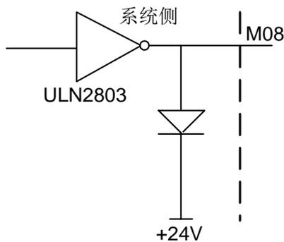
图4-13-1 M08内部电路
