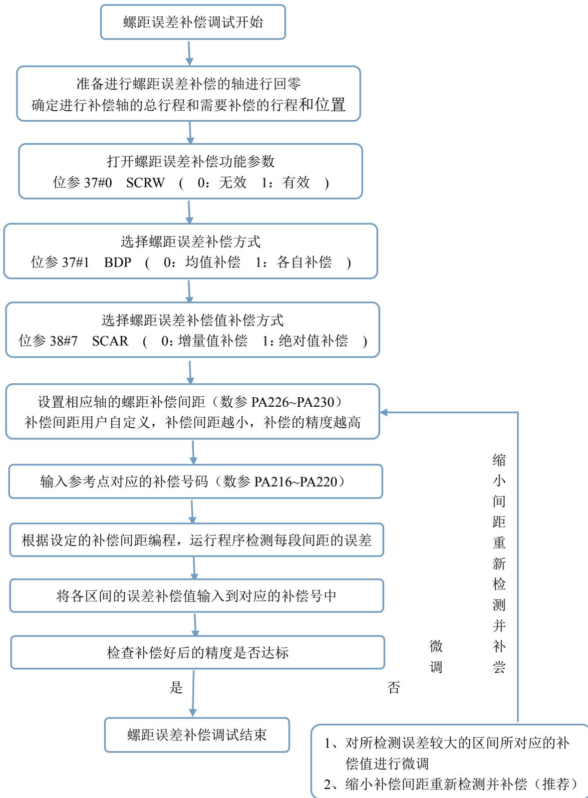
图 4-7-2-1 螺距补偿调试流程图
