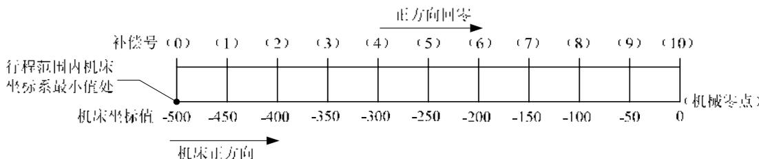
图 4-7-4-2 正方向回零参考点补偿号说明
