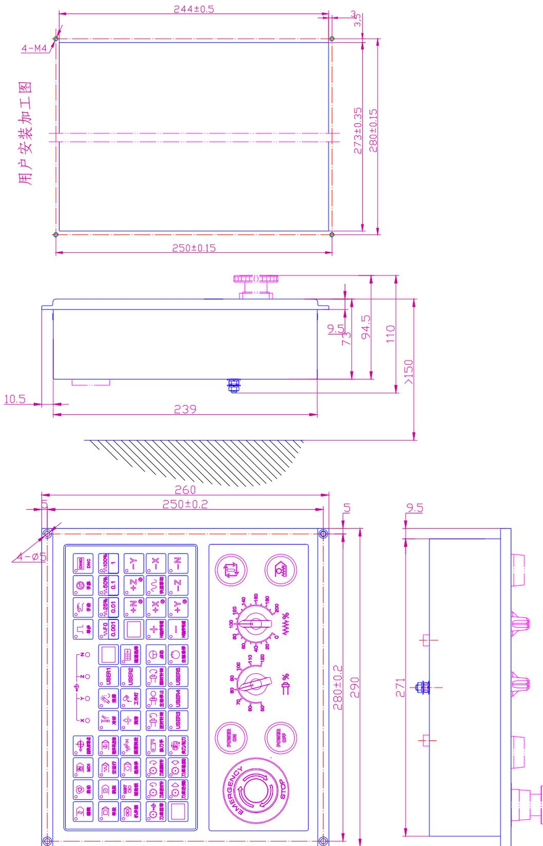
图 1-3-5 GSK218MC-V 操作面板安装尺寸图
