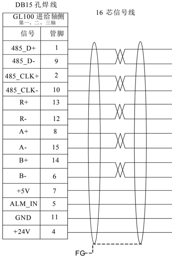
图 2-2-6-2 连接光栅等反馈编码器信号线
