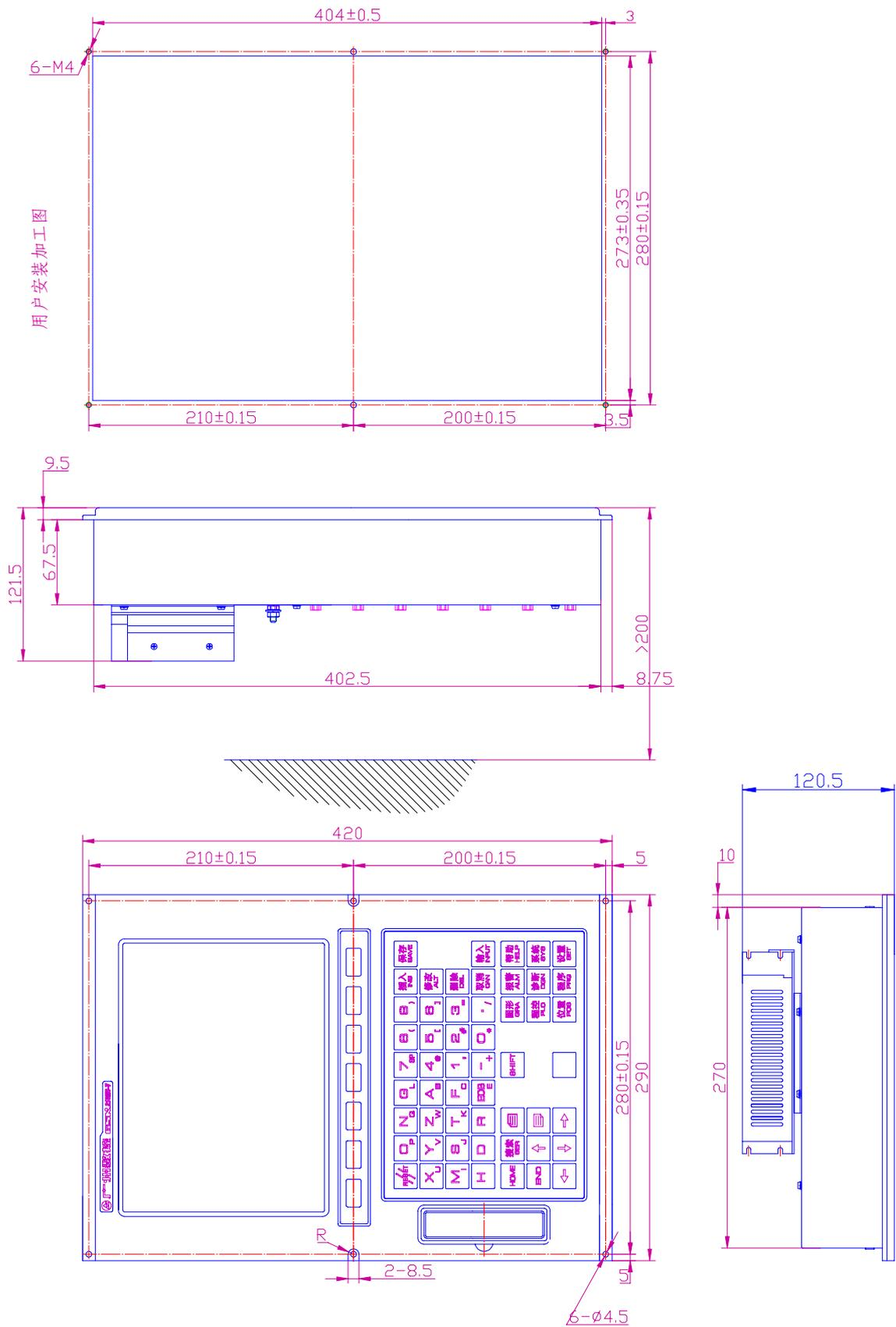
图 1-3-4 GSK218MC-V 编辑面板安装尺寸图
