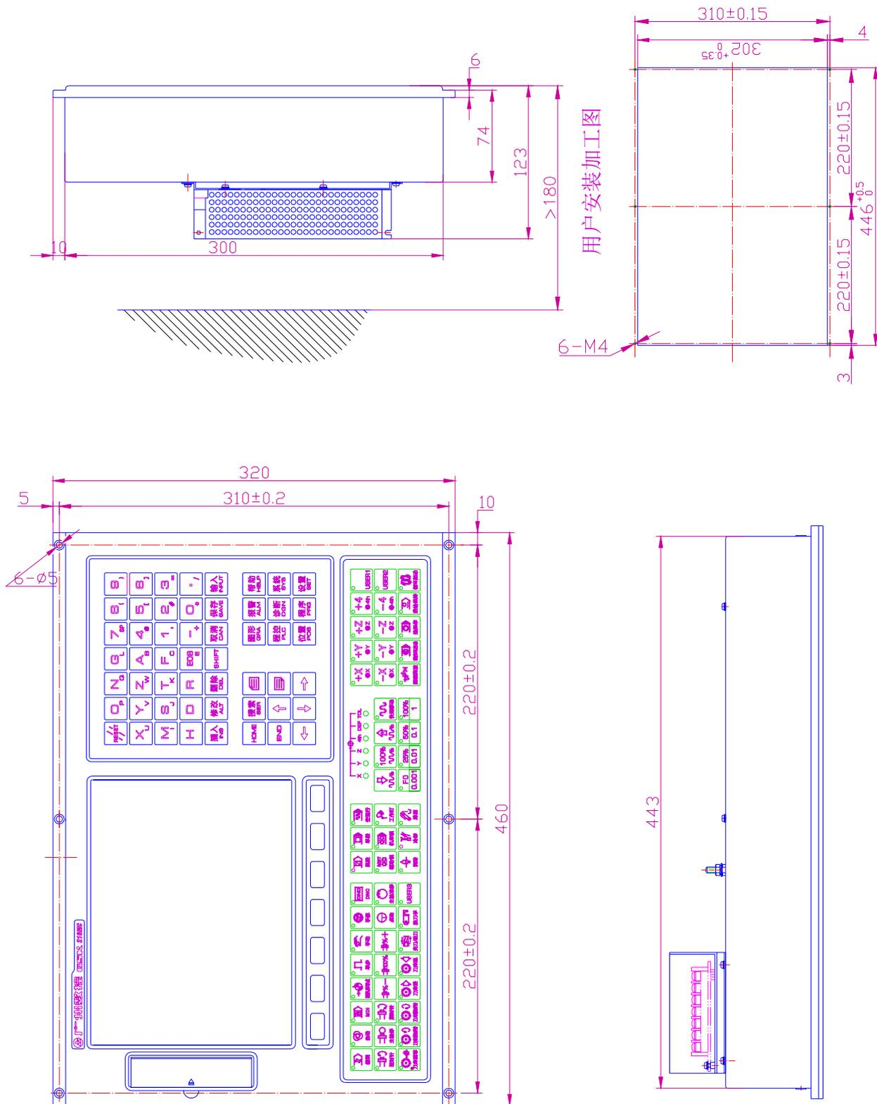
图 1-3-1 GSK218MC 面板系统安装尺寸图
