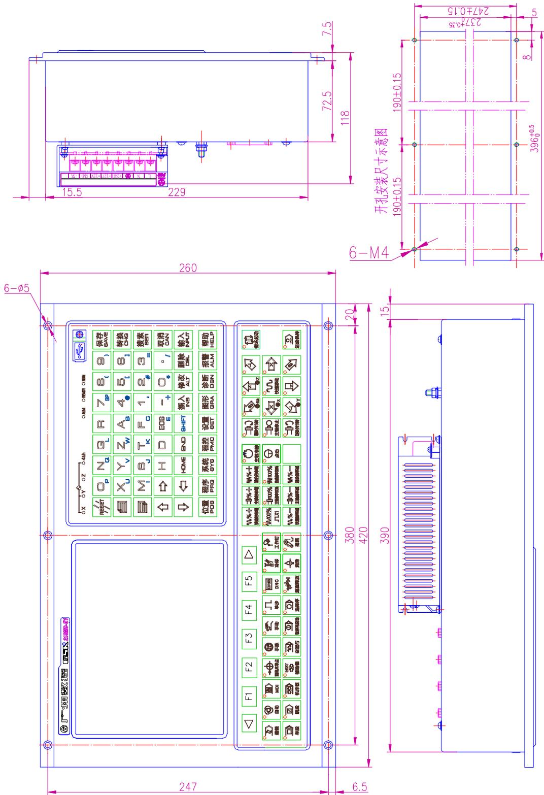
图 1-3-6 GSK218MC-U1 操作面板安装尺寸图
