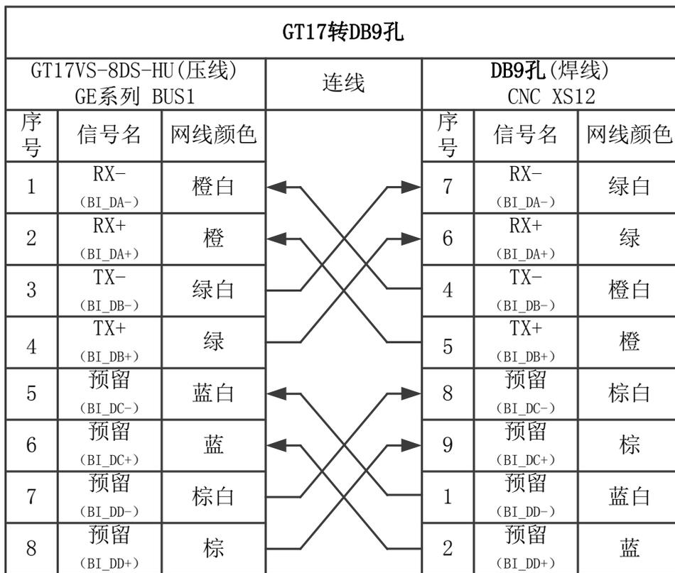
图 2-2-5-2 CNC 端的总线接口 2 与驱动单元的连接
