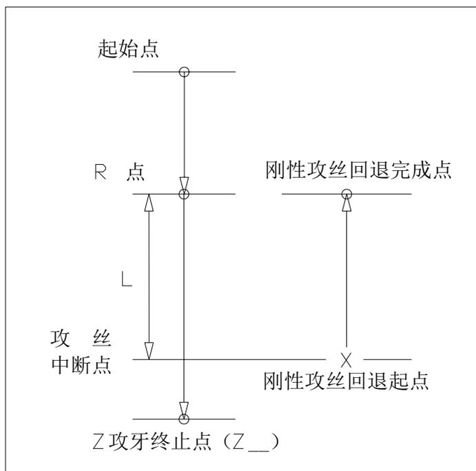
图8-3-1 刚性攻丝回退示意图
