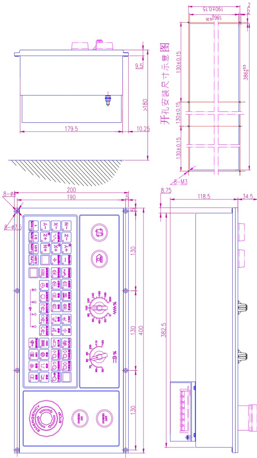
图 1-3-3 GSK218MC-H 操作面板安装尺寸图
