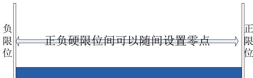
图 4-8-2-2 绝对编码器零点设置
